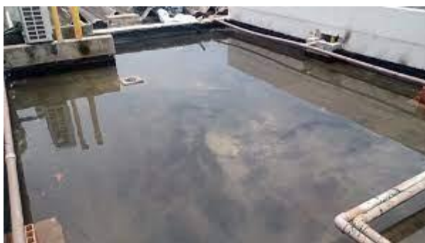
Figura 4: Teste de estanqueidade por lâmina d'água.
